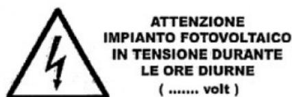
Poiché il generatore fotovoltaico è installato sulla copertura, detta segnaletica dovrà essere installata in corrispondenza di tutti i varchi di accesso del fabbricato.
