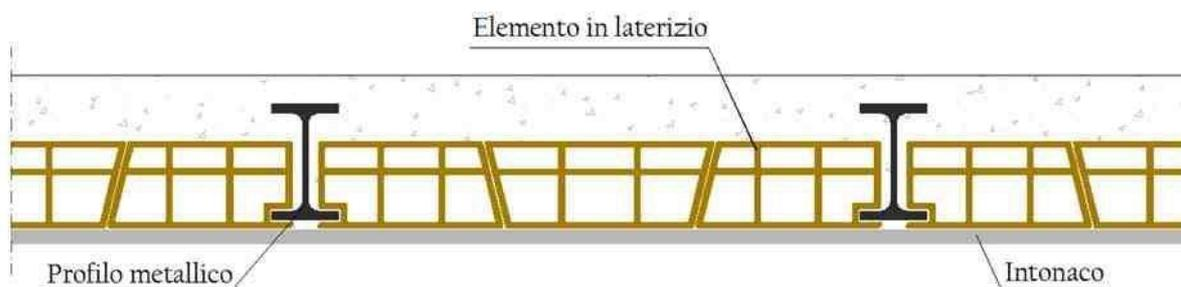
Dalle misurazioni effettuate su di una trave, i profili sono di tipo IPN 240 con interasse di circa 1.00 m con una luce di 7.10 m circa.
