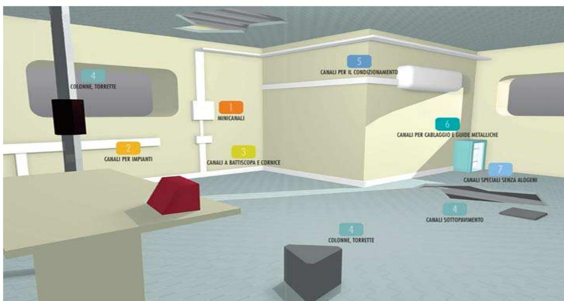
Figura 1 - Esempi di applicazione dei sistemi di canalizzazione
