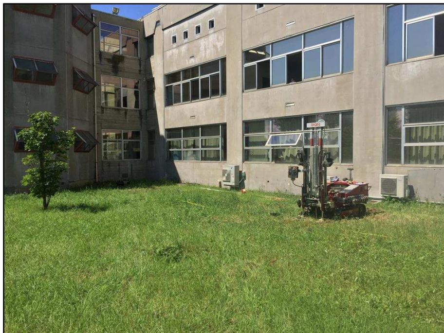
**Figura 4:** Postazione della prova penetrometrica PSD.2(Statica/Dinamica)
