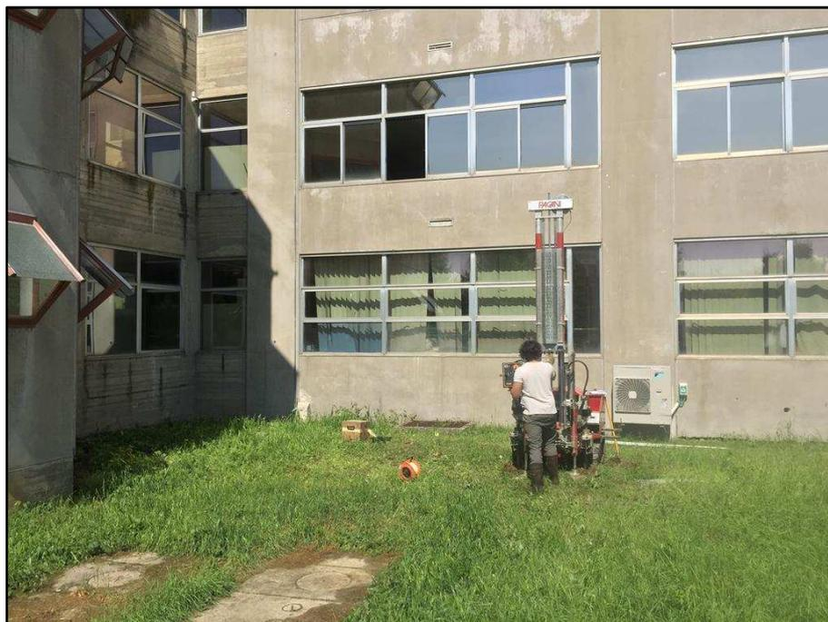
Figura 3: Postazione della prova penetrometrica PS.1(Statica)
