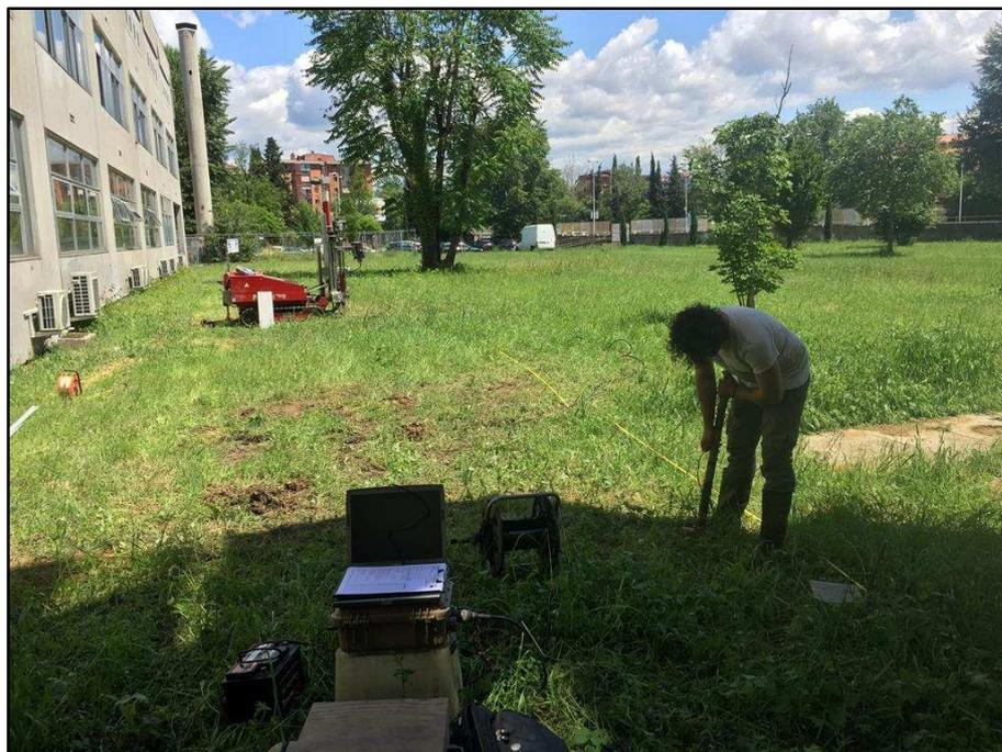
**Figura 5:** Stesa Sismica MASW
